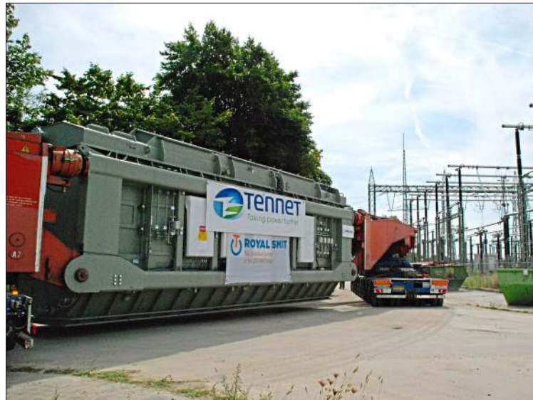
Im Umspannwerk angekommen, muss der Koloss nochmal um die Kurve. Möglich machen das die beiden Gelenke zwischen der Zug- und der Schubmaschine, die jeweils zwölf Achsen haben.
